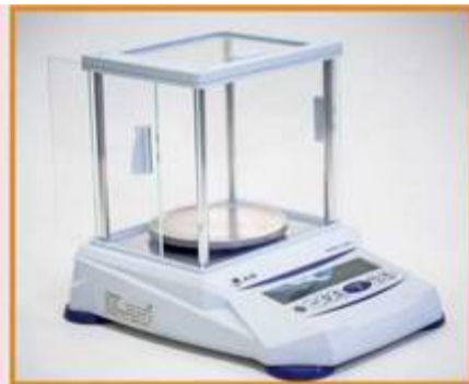
Chambre équipée de 3 ouvertures coulissantes
