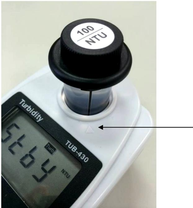
\* Lors de la calibration ou de la mesure, aligner la ligne sur la cuve avec la flèche sur l'instrument (voir photo ci-dessus).
